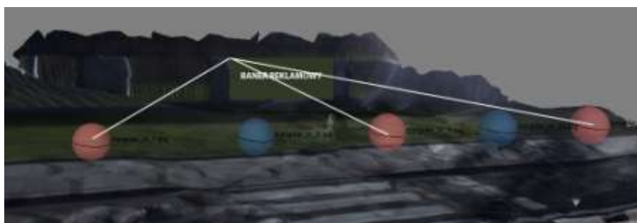
Ryc. 5 Wizualizacja w trzech wymiarach zasady MultiClick Measurement. Zaznaczone sfery to pojedyncze klatki wideo immersyjnego wybrane do pomiarów.
