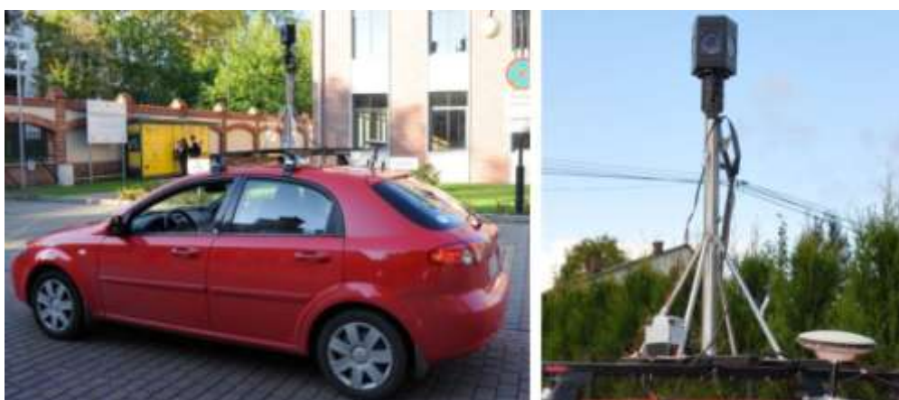
Ryc. 3 Zestaw do mobilnego kartowania umieszczony na samochodzie oraz zbliżenie na kamerę Ladybug®3, składającą się z 6 kamer wideo.
